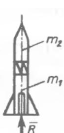
**Вопрос 10.** Двухступенчатая ракета в момент пуска с поверхности Земли в вертикальном направлении развивает реактивную силу  $R = 90 \text{ кН}$ . Массы ступеней ракеты равны  $m_1 = 200 \text{ кг}$ ,  $m_2 = 100 \text{ кг}$ . Определить силу давления в кН между ступенями ракеты в момент пуска.
