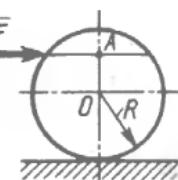
**Вопрос 4.** К однородному катку весом 2 кН приложена горизонтальная сила F. Определить наибольший модуль силы F, при котором каток не скользит и не катится, если коэффициент трения качения  $\delta = 0,006$  м, коэффициент трения скольжения  $f = 0,2$ , радиус R = 0,6 м, размер OA = 0,4 м.
