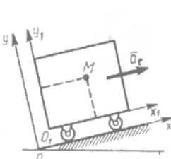
**Вопрос 9.** Тележка движется по наклонной плоскости с ускорением  $a_e = 2 \text{ м/с}^2$ . По тележке в плоскости чертежа движется точка M согласно уравнениям  $x_1 = 3t^2$  и  $y_1 = 4t^2$ . Определить абсолютное ускорение точки.
