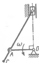
**Вопрос 7.** Определить угловую скорость кривошипа  $OA$  в указанном положении, если скорость точки  $C$  шатуна  $V_C = 4$  м/с, длина кривошипа  $OA = 0,2$  м.
