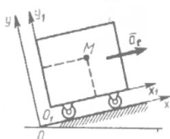
**Вопрос 9.** Тележка движется по наклонной плоскости с ускорением  $a_e = 2$  м/с<sup>2</sup>. По тележке в плоскости чертежа движется точка  $M$  согласно уравнениям  $x_1 = 3t^2$  и  $y_1 = 4t^2$ . Определить абсолютное ускорение точки.
