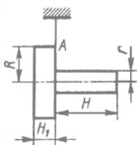
**Вопрос 10.** Определить высоту  $H$  однородного цилиндра, при которой ось симметрии тела, состоящего из двух цилиндров и подвешенного в точке  $A$ , будет горизонтальной. Высота цилиндра  $H_1 = 0,5 \text{ м}$ , радиус  $R = 3r$ .
