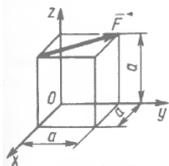
**Вопрос 8.** Определить момент силы  $\vec{F}$  относительно оси  $Ox$ , если ее значение  $F = 16 \text{ Н}$ , ребро куба  $a = 0,75 \text{ м}$ .
