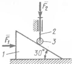
**Вопрос 6.** На призму 1 действует сила  $F_1 = 100 \text{ Н}$ . Определить силу  $F_2$ , которую необходимо приложить к стержню 2, шарнирно связанному с роликом 3 для равновесия системы.
