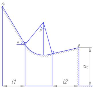
указанного профиля. На криволинейном участке радиуса  $R$  и при свободном полете тело не испытывает сопротивления. На участке  $l_1$  действует сила трения с коэффициентом  $f$ , на участке  $l_2$  - сила сопротивления  $f_C = k_o m V^n$ , пропорциональной скорости в  $n$ -ой степени.
