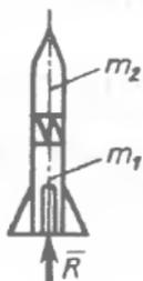
**Вопрос 10.** Двухступенчатая ракета в момент пуска с поверхности Земли в вертикальном направлении развивает реактивную силу  $R = 90$  кН. Массы ступеней ракеты равны  $m_1 = 200$  кг,  $m_2 = 100$  кг. Определить силу давления в кН между ступенями ракеты в момент пуска.
