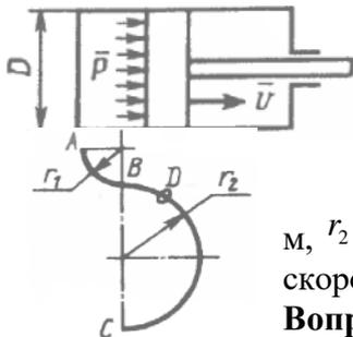
**Вопрос 5.** На поршень гидроцилиндра действует давление масла  $p = 10$  Н/мм<sup>2</sup>. Диаметр поршня  $D = 100$  мм, его скорость  $V = 0,2$  м/с. Определить в кВт мощность силы давления масла.
