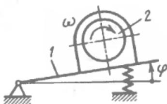
**Вопрос 10.** Платформа 1 совершает колебания по закону  $\varphi = 0,1 \cdot \sin(10\pi \cdot t)$ . Якорь 2 двигателя вращается относительно статора с угловой скоростью  $\omega = 7$  рад/с. Определить максимальное значение абсолютной угловой скорости якоря.
