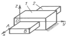
**Вопрос 6.** В корпусе 1 по направляющим перемещается ползун 2 по закону  $x_A = 0,1 \cos(t)$ ,  $z_A = 0$ . В момент времени (с)  $t' = \pi$  определить скорость точки В, если расстояние  $AB = 0,3$  м.
