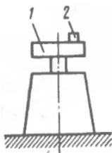
**Вопрос 9.** Горизонтальная платформа вибростенда 1 совершает в вертикальном направлении гармонические колебания с амплитудой 8 мм и частотой 8 Гц. К платформе прикреплен датчик 2 массой 50 г. Определить максимальное значение силы, которая стремится оторвать датчик от платформы.
