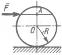
**Вопрос 4.** К однородному катку весом  $2 \text{ кН}$  приложена горизонтальная сила  $F$ . Определить наибольший модуль силы  $F$ , при котором каток не скользит и не катится, если коэффициент трения качения  $\delta = 0,006 \text{ м}$ , коэффициент трения скольжения  $f = 0,2$ , радиус  $R = 0,6 \text{ м}$ , размер  $OA = 0,4 \text{ м}$ .
