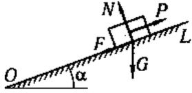
Телу массой  $m$  сообщена начальная скорость  $v_0$ , направленная вверх по наклонной плоскости, составляющей угол  $\alpha$  с горизонтом. На тело действует сила  $\vec{P}$ , направленная в ту же сторону (рис.). Зная закон изменения силы  $P = P(t)$  и коэффициент трения скольжения  $f$ , определить скорость тела в моменты времени  $t_1, t_2, t_3$  и проверить полученный результат для момента времени  $t_1$  с помощью дифференциального уравнения движения.
