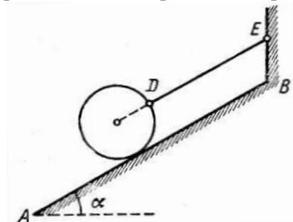
2. На гладкой наклонной плоскости  $AB$ , образующей с горизонтом угол  $\alpha = 30^\circ$  при помощи веревки  $DE$ , параллельной плоскости  $AB$ , удерживается однородный шар весом  $G=4$  Н. Чему равно натяжение веревки?
