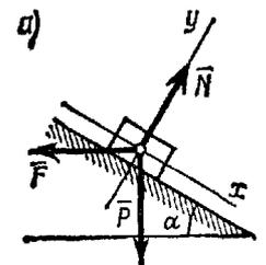
15. Груз весом  $P$  лежит на гладкой наклонной плоскости с углом наклона  $\alpha$ . Определить, значение силы давления  $N$  груза на плоскость, чтобы удержать его в равновесии.
