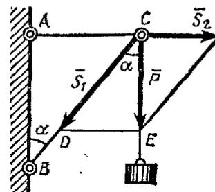
11. Кронштейн состоит из стержней  $AC$  и  $BC$ , соединенных со стеной и друг с другом шарнирами, причем угол  $BAC=90^\circ$ , угол  $ABC=\alpha$ . В точке  $C$  подвешен груз весом  $P$ . Чему равно усилие в стержне  $S_1$ ?
