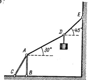
10. Груз весом  $G=518H$  подвешен в точке  $D$  к канату  $ADE$ , участок которого  $AD$  составляет с горизонталью угол  $30^\circ$ , а участок  $DE$  – угол  $45^\circ$ . В точке  $A$  канат привязан к вертикальному столбу  $AB$ , поддерживаемому подкосом  $AC$ , наклоненным к горизонтали под углом  $60^\circ$ . Определить какой вид деформации испытывает подкос?
