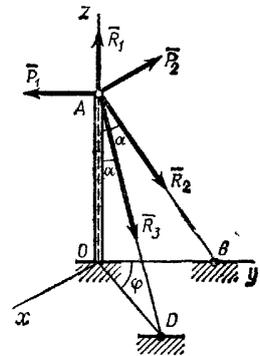
19. Стоящий на земле вертикальный столб  $OA$  удерживается растяжками  $AB$  и  $AD$ , образующими со столбом равные углы  $\alpha$ ; угол между плоскостями  $AOB$  и  $AOD$  равен  $\varphi$ . К столбу подвешены два горизонтальных провода; один, параллельный оси  $Oy$ , натянут с силой  $P_1$ , а другой, параллельный оси  $Ox$ , — с силой  $P_2$ . Найти и усилия в тросе  $R_2$ .
