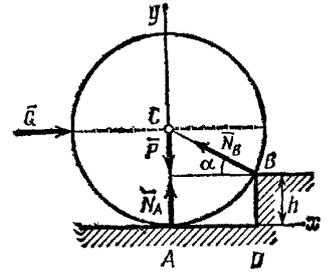
17. На цилиндр весом  $P$ , лежащий на гладкой горизонтальной плоскости, действует горизонтальная сила  $Q$ , прижимающая его к выступу  $B$ . Определить реакцию в точке  $B$ .
