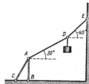
7. Груз весом  $G = 518H$  подвешен в точке  $D$  к канату  $ADE$ , участок которого  $AD$  составляет с горизонталью угол  $30^\circ$ , а участок  $DE$  – угол  $45^\circ$ . В точке  $A$  канат привязан к вертикальному столбу  $AB$ , поддерживаемому подкосом  $AC$ , наклоненным к горизонтали под углом  $60^\circ$ . Чему равно усилие в столбе?
