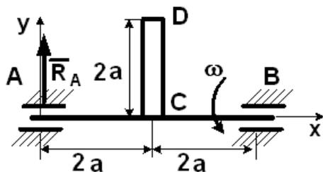
Полная реакция подшипника в точке A равна  $R_A = \dots$
