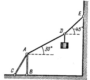
9. Груз весом  $G=518H$  подвешен в точке  $D$  к канату  $ADE$ , участок которого  $AD$  составляет с горизонталью угол  $30^\circ$ , а участок  $DE$  – угол  $45^\circ$ . В точке  $A$  канат привязан к вертикальному столбу  $AB$ , поддерживаемому подкосом  $AC$ , наклоненным к горизонтали под углом  $60^\circ$ . Определить какой вид деформации испытывает столб?
