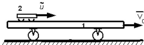
Общая скорость платформы вместе с тележкой, после остановки тележки равна ... (м/с)
