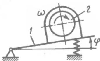
**Вопрос 10.** Платформа 1 совершает колебания по закону  $\varphi = 0,1 \cdot \sin(10\pi \cdot t)$ . Якорь 2 двигателя вращается относительно статора с угловой скоростью  $\omega = 7 \text{ рад/с}$ . Определить максимальное значение абсолютной угловой скорости якоря.
