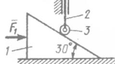
**Вопрос 6.** На призму 1 действует сила  $F^1 = 100$  Н. Определить силу  $F^2$ , которую необходимо приложить к стержню 2, шарнирно связанному с роликом 3 для равновесия системы.
