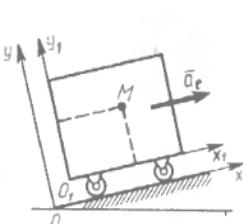
**Вопрос 9.** Тележка движется по наклонной плоскости с ускорением  $a_e = 2 \text{ м/с}^2$ . По тележке в плоскости чертежа движется точка M согласно уравнениям  $x_1 = 3t^2$  и  $y_1 = 4t^2$ . Определить абсолютное ускорение точки.
