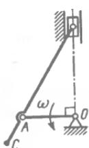
**Вопрос 7.** Определить угловую скорость кривошипа OA в указанном положении, если скорость точки C шатуна  $V_C=4 \text{ м/с}$ , длина кривошипа OA = 0,2 м.
