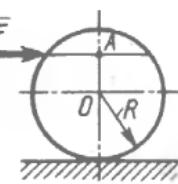
**Вопрос 4.** К однородному катку весом 2 кН приложена горизонтальная сила F. Определить наибольший модуль силы F, при котором каток не скользит и не катится, если коэффициент трения качения  $\delta = 0,006$  м, коэффициент трения скольжения  $f = 0,2$ , радиус R = 0,6 м, размер OA = 0,4 м.
